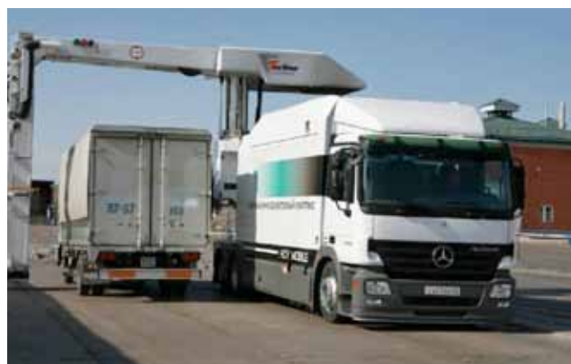
Проверка груза с помощью мобильной аппаратуры в России.
