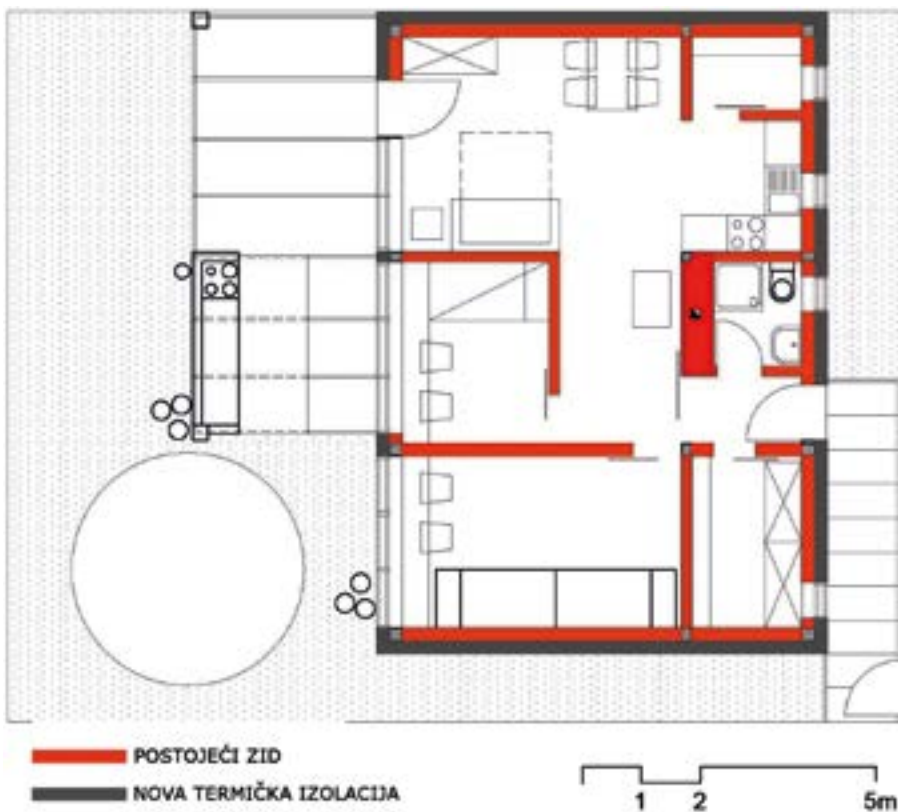
Цртеж 14: Пример постављања термоизолације на кући која је незавршена
