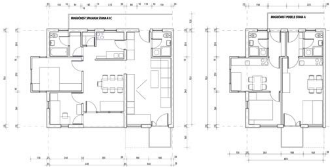
Цртеж 21: Основа стана са могућношћу поделе и спајања стана
