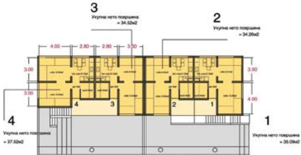
Цртеж 15: План приземља за непрофитне станове за локацију В.М. Луг у Београду (аутор Зорица Савичић)
