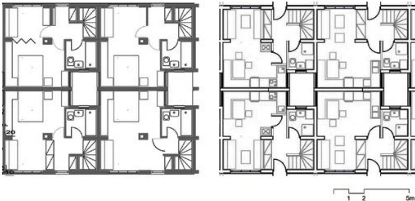
Цртеж 43: Развојне куће типа СОЛЕКО која се развија око светларника кухиње и купатила
