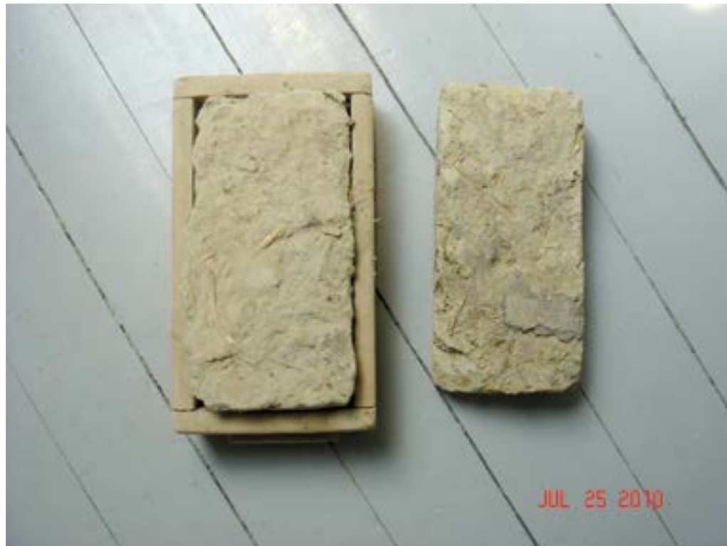
Слика 40: Изглед налупа за израду и готовог ћерлица
