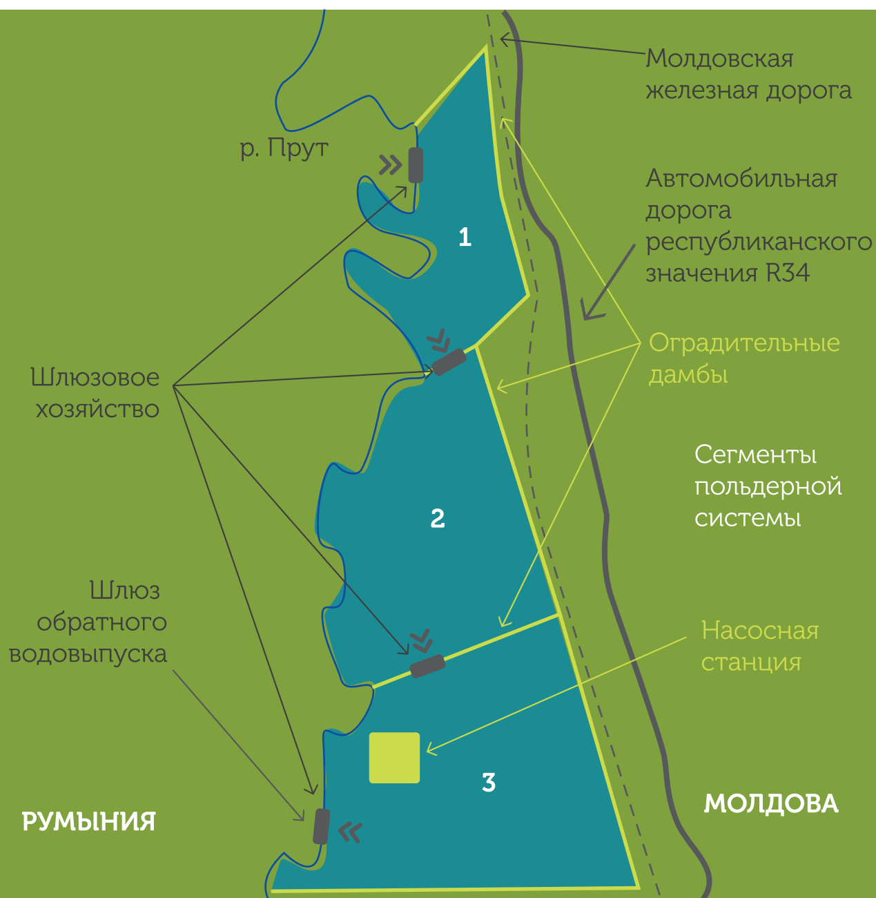
Рисунок 5. Концепт-схема проектируемой польдерной системы на р. Прут, Молдова
