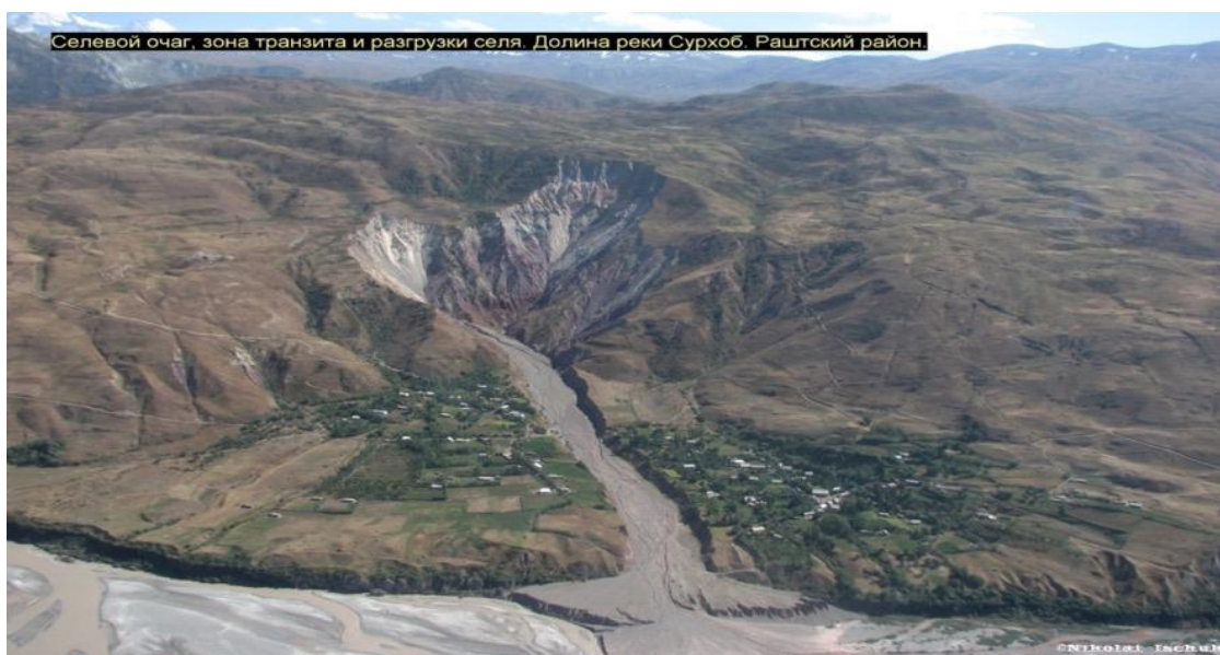
Рисунок 3. - Классическая структура селя в селе Обчака в долине реки Сурхоб, показывающая зону зарождения, транзита и аккумуляции (фото Н. Ицука).
